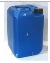
Proceso : SOPLADO : POLIETILENO DE ALTO PESO MOLECULAR Material Color : AZUL Tara : 1150 ± 58 g. Capacidad : 20 L. Cámara de aire : 2450 cc. Resistencia Impacto: 1,2 m. Superficie : LISA
